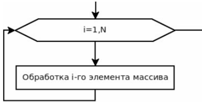
Рисунок 5.5: Блок-схема обработки элементов массива с использованием цикла *for*
