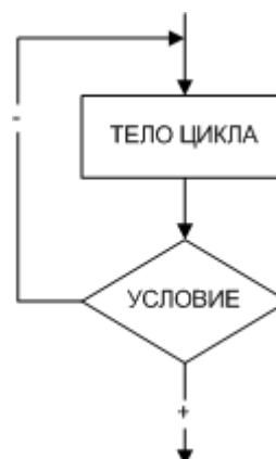
Рис. 5.2. Алгоритм циклической структуры с постусловием
