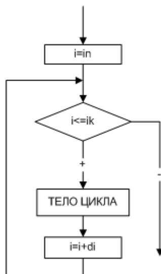
Рис. 5.4. Условный циклический алгоритм с известным числом повторений
