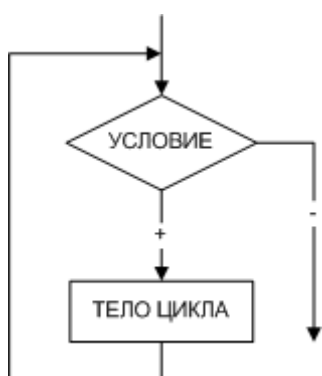
Рис. 5.1. Алгоритм циклической структуры с предусловием
